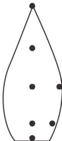
Рис. 1. Точки измерения температуры пламени
